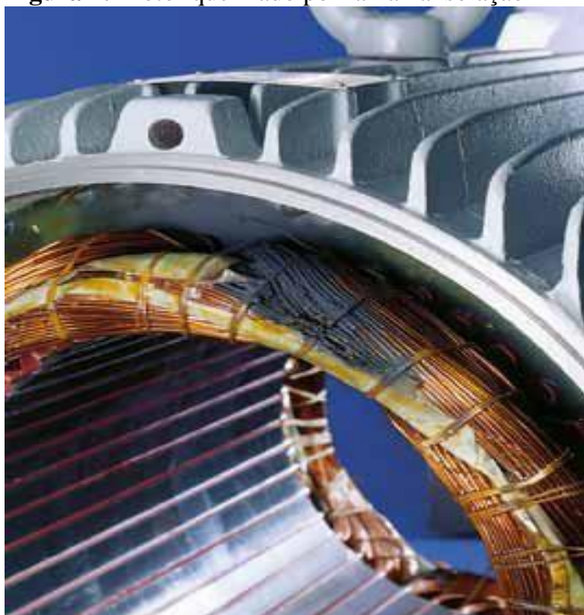
Figura 7: Motor queimado por falha na isolação
