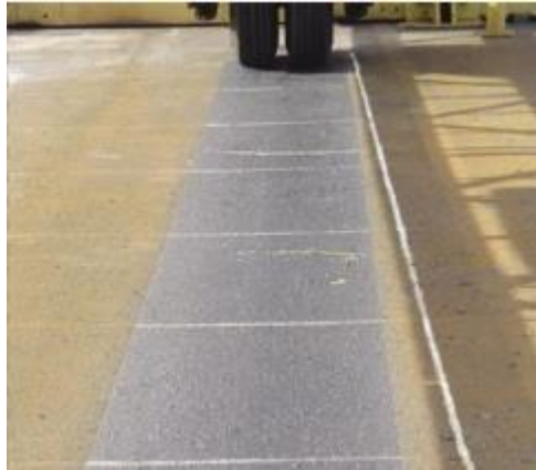
Figura 3- Asfalto de borracha com 300000 ciclos
